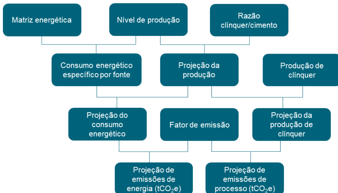
Figura 7: Esquema simplificado do método para estimativa das emissões no setor de cimento
