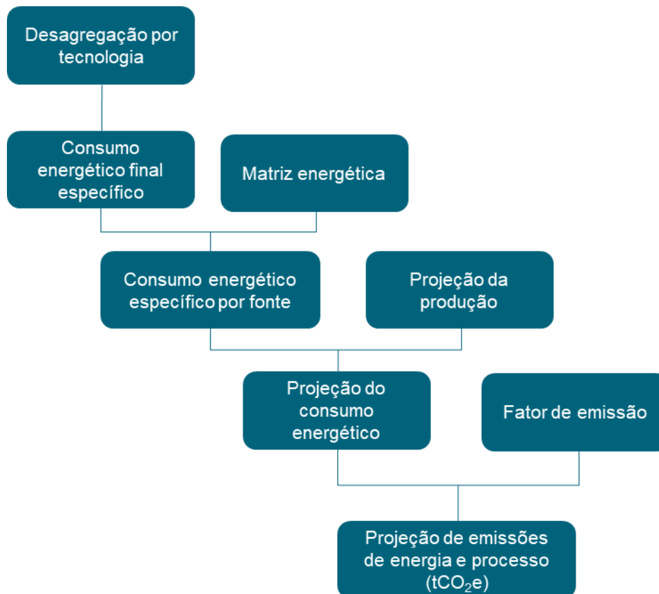
Figura 6: Esquema simplificado do método utilizado para estimativa de emissões no setor de ferro-gusa e aço
